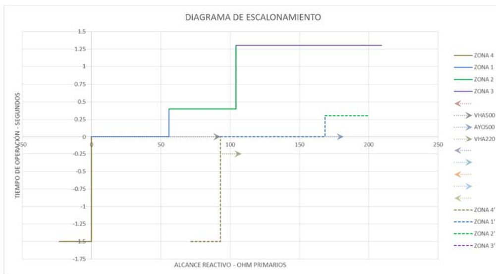
Figura 50 Diagrama de escalonamiento de la función 21 (propuesto) de la línea VHA-MD - extremo MD
