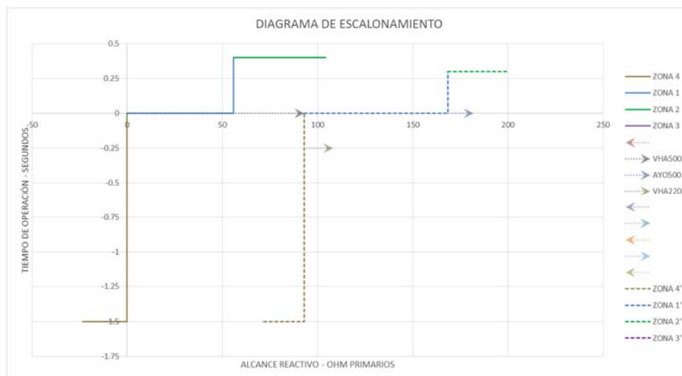
Figura 49 Diagrama de escalonamiento de la función 21 (actual) de la línea VHA-MD - extremo MD
